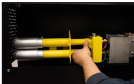
6 - Retirar el quemador del compartimento
