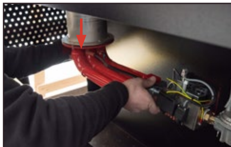
5 - Sfilare il bruciatore dal suo alloggio
