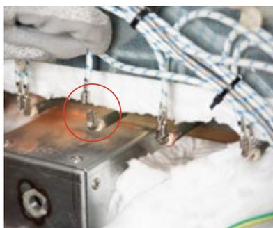
4. A questo punto disconnettere i 2 fastoni di collegamento elettrico e svitare le 2 viti che fissano la resistenza alla struttura del forno. Una volta svitate le 2 viti di fissaggio.
