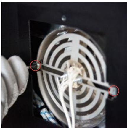
2. Svitare le 2 viti di fissaggio sulla griglia di bloccaggio ed estrarre la lampada per la sostituzione.
