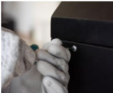
1. Smontare il carter verniciato laterale destro svitando le viti di fissaggio (utilizzare un giravite a stella).
