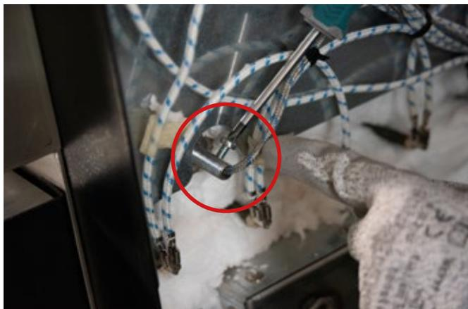
1. Per effettuare la sostituzione della sonda rimuovere il carter laterale (vedi pag. accanto) provvedere quindi ad allentare la vite di fermo con un cacciavite a stella.
