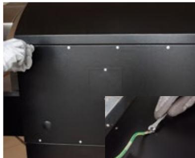
2. Una volta svitate tutte le viti, potete procedere a rimuovere il pannello laterale. È consigliabile eseguire l'operazione in due fasi da evitare di causare danni al forno o al circuito elettrico interno.
