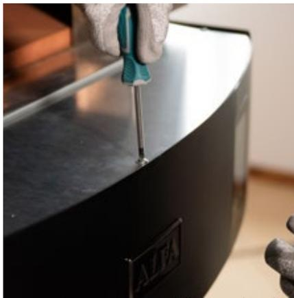
2. Svitare le 3 viti di blocco della protezione in acciaio
