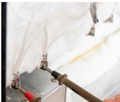
3. Individuare la resistenza danneggiata verificando la continuità di corrente tra un polo e l'altro delle resistenze tramite l'ausilio di un tester. (Questa operazione deve essere fatta da un tecnico specializzato).
