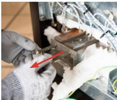
5. Una volta svitate le 2 viti di fissaggio estrarre e sostituire la resistenza.
